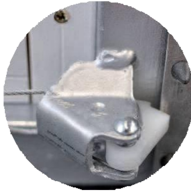
Die seitliche Verriegelung mit den Pfullendorfer Schließriegeln
